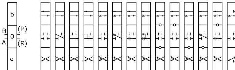
P, A, Q, K y T con solapamiento positivo
